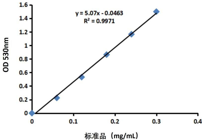
2、总果胶含量(mg/g 重量)=[ $(\Delta A + 0.0463) \div 5.07 \times V1$ ] $\div (W \times V1 \div V) \times D$
