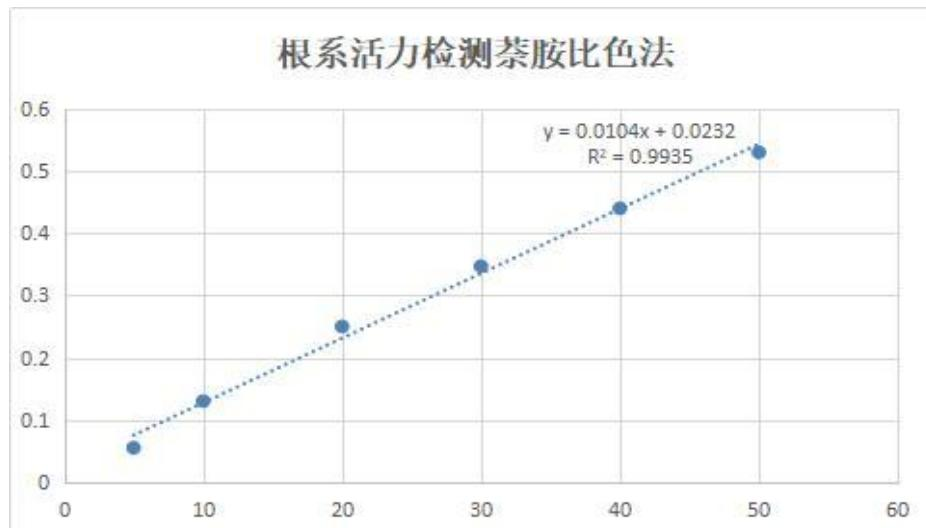
注意：由于检测仪器和操作手法等条件的不同，参考值范围会有波动，该值仅供参考，对于要求精确计算根系活力的，可以采用标准曲线进行多点重复测定；根据 测定经验显示 萘胺浓度在 7μg/ml 以下，萘胺浓度在 50μg/ml 以上，标准曲线会有偏差。
